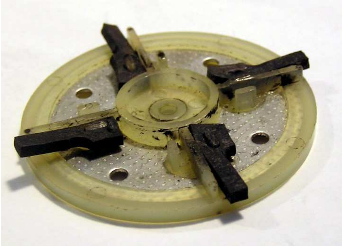
Kupplung mit neuen Ersatzgummis/ clutch with new rubbers
